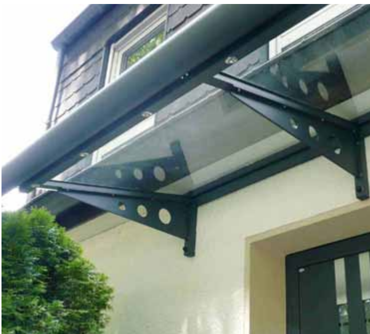
Vordachmodell V 30/I mit runden Ausschnitten in den Tragarmen und einer runden Regenrinne. Überstand je Seite 100 mm. Abbildung mit Lichtleiste und LED-Spots.
